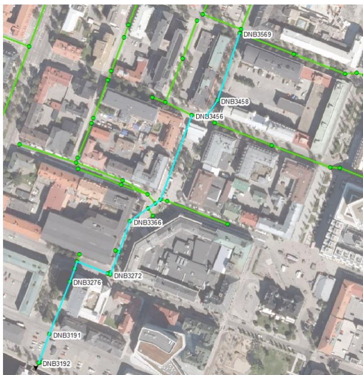
Figur 4 Ortofoto med dagvattennät där stäckning på studerad tryckprofil markerats.
