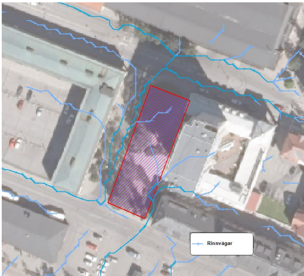
Figur 14 Rinnvägar för ytvatten vid 100-årsregn (Umeå kommuns skyfallsmodell).
