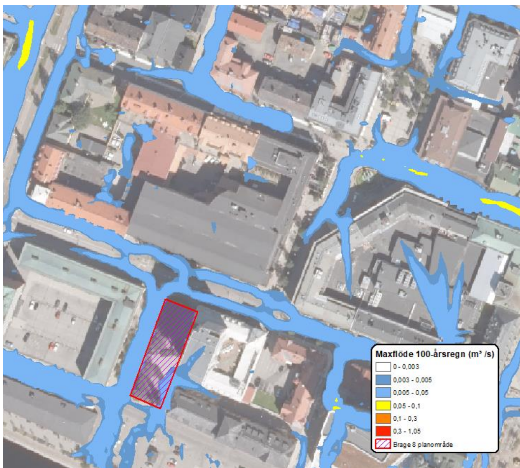
Figur 16 Flöden vid 100-årsregn (Umeå kommuns skyfallsmodell). Det är viktigt att en yta hålls öppen mot tullkammaren för att inte skapa ett instängt område.
