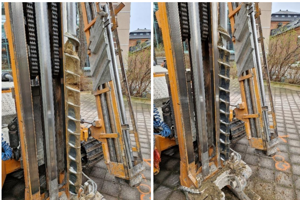
Figur 5. Provpunkt 25T03. Skruven t.v. representerar övergången från sand till den svarta sulfid-siltan på 3-4 m.u.my. Skruven t.h. representerar 4-5 m.u.my.
