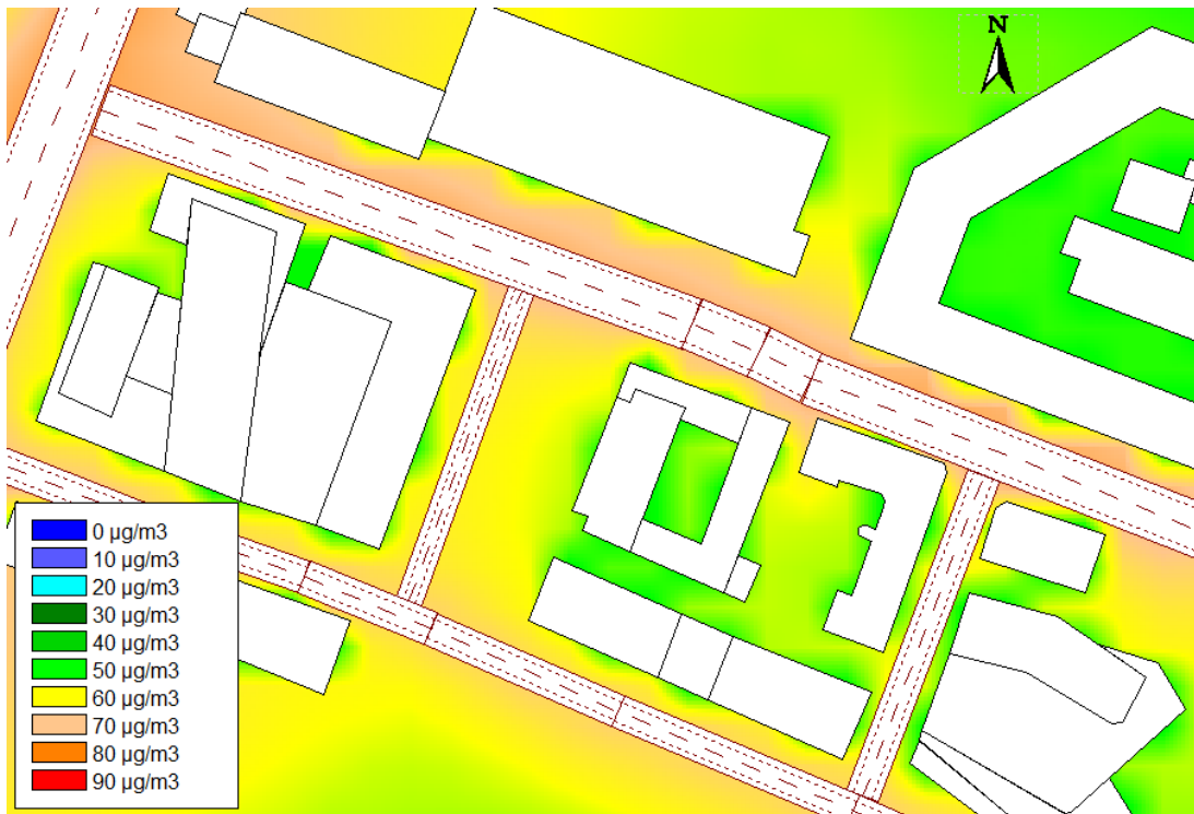
Figur 9. Kvävedioxid som 98-percentilen för timmedelvärden – Nuläge: år 2025. Detaljplaneområdet är markerat i kartan.
