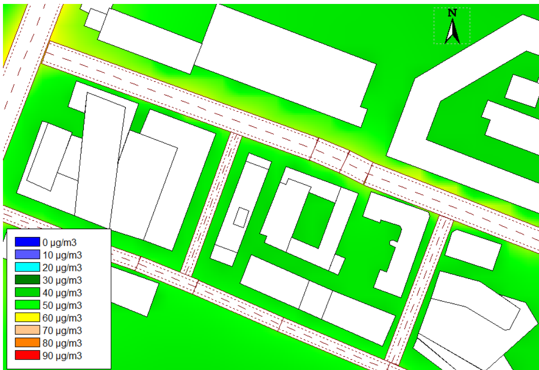
Figur 10. Kvävedioxid som 98-percentilen för timmedelvärden för år 2030, med bostäder samt detaljplaneområdet markerat i kartan.
