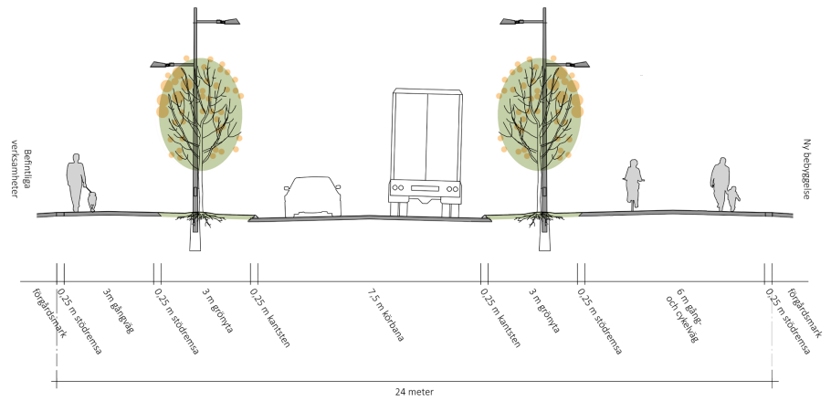
Figur 28. Normalsektion för Söderslättsvägen. Sektionen kan komma att justeras i framtida planarbete.
