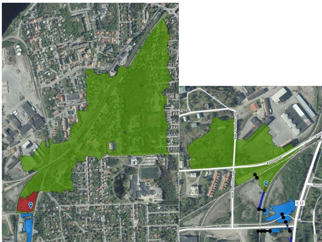
Figur 16. Påtryckande avrinningsområden som förbileds genom hamnområdet. Framtaget med Scalco Live. Svarta punkter anger ungefärlig placering av trummor.
