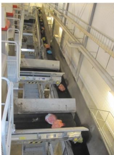
Figur 5 Transportband med olikfärgade påsar som sorteras efter färg med hjälp av optisk avläsning. Exempel från Eskilstuna. Foto: Optibag AB
