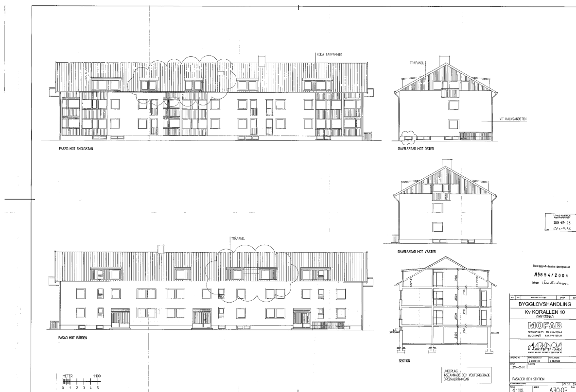
2004 fönster på gavelfasad mot öster. Ombyggnad av skyddsrum i källarvåning till lägenhetsförråd. Ombyggnad av lägenhetsförråd på vind till 2st lägenheter inkl. takfönster.
