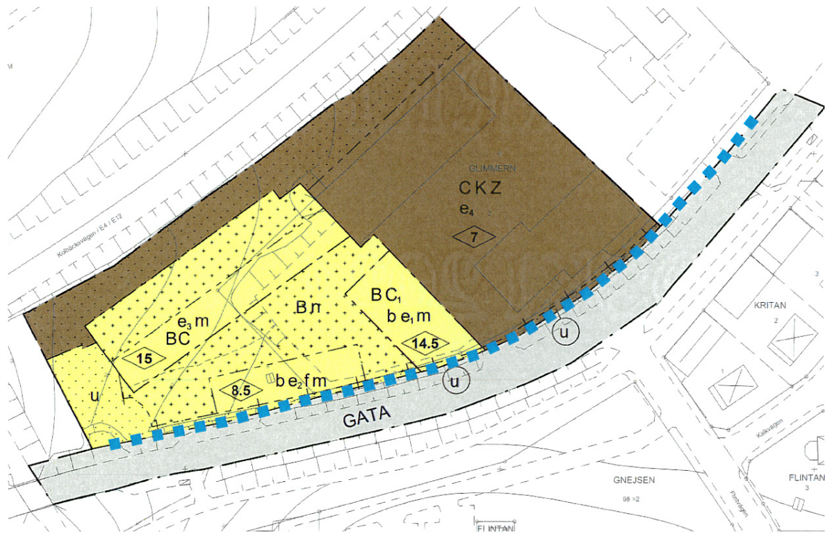
Blå markering visar ungefärlig sträckning av ny gångbana som ska anläggas enligt §3.1
