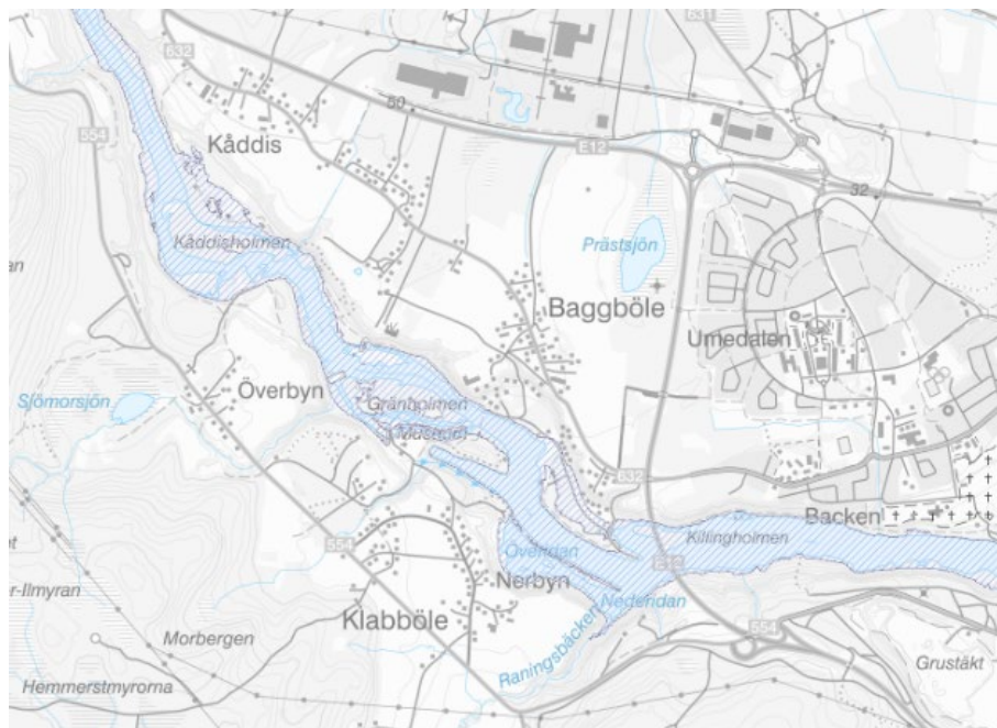
Figur 25. Översvämningskartering av Umeälven vid Baggböle. Visar beräknat högsta flöde (BHF) i dagens klimat. (MSB, 2022)
