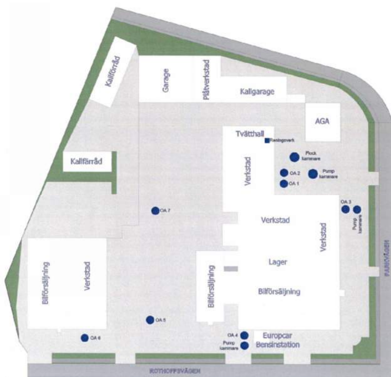
Figur 3. Oljeavskiljare inom fastigheten 2015-09-23.
