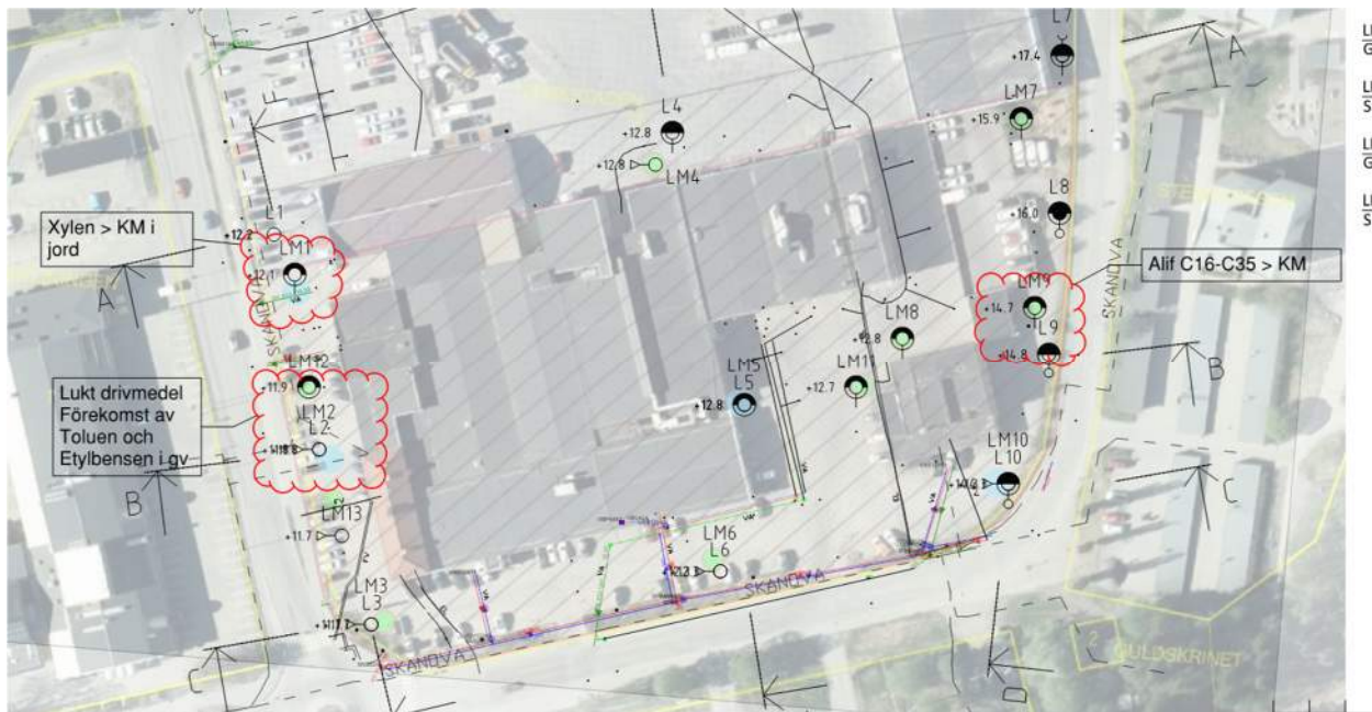
Figur 5. Noteringar på borrhplan med fältnoteringar och analysresultat som påvisar förorening inom fastigheten.
