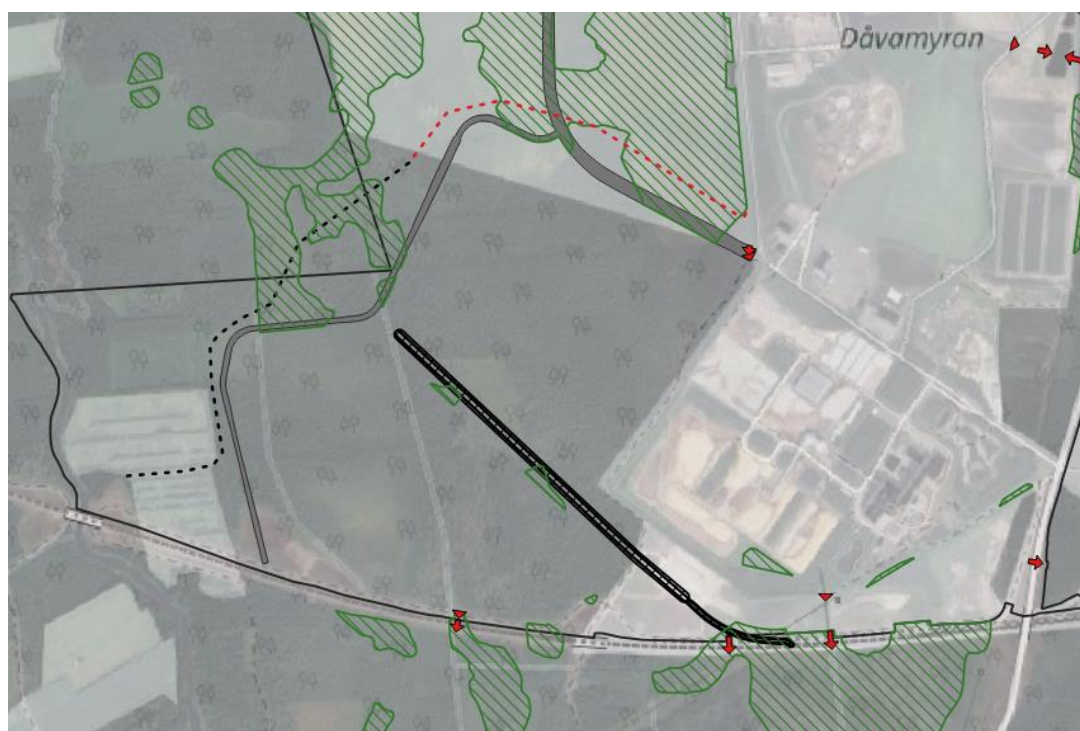
Figur 2.12 Alternativ 1 – flödesavledningskulvert och kanalen (avledningskulvert = streckad röda linje; kanalen = röd linje; markavvattningsföretag = ljusblå linjer; detaljplanegräns = svart linje; ytliga flödeslinjer = mörkblå linjer)
