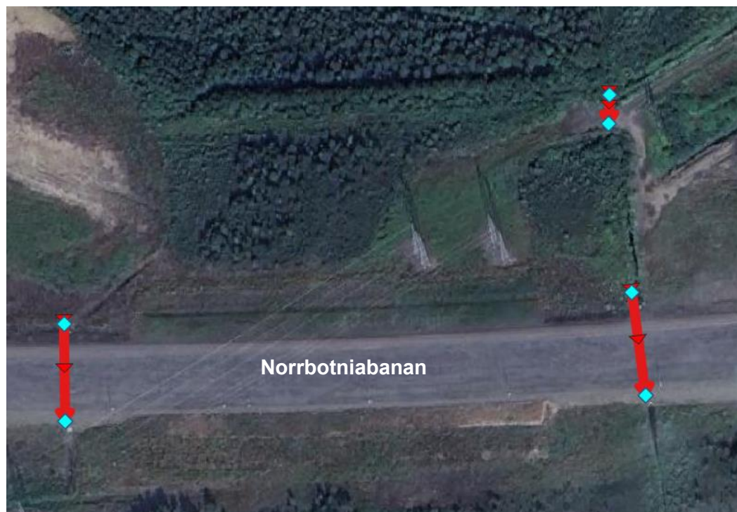
Figur 2.6 Tre kulverter beskrivna i modellen – röda linjer är polylinjer för kulvertar i 1D-nätverket och blåa punkter beteckna en 'SX' kopplings punkt mellan 1D- strukturen och 2D-terrängen.
