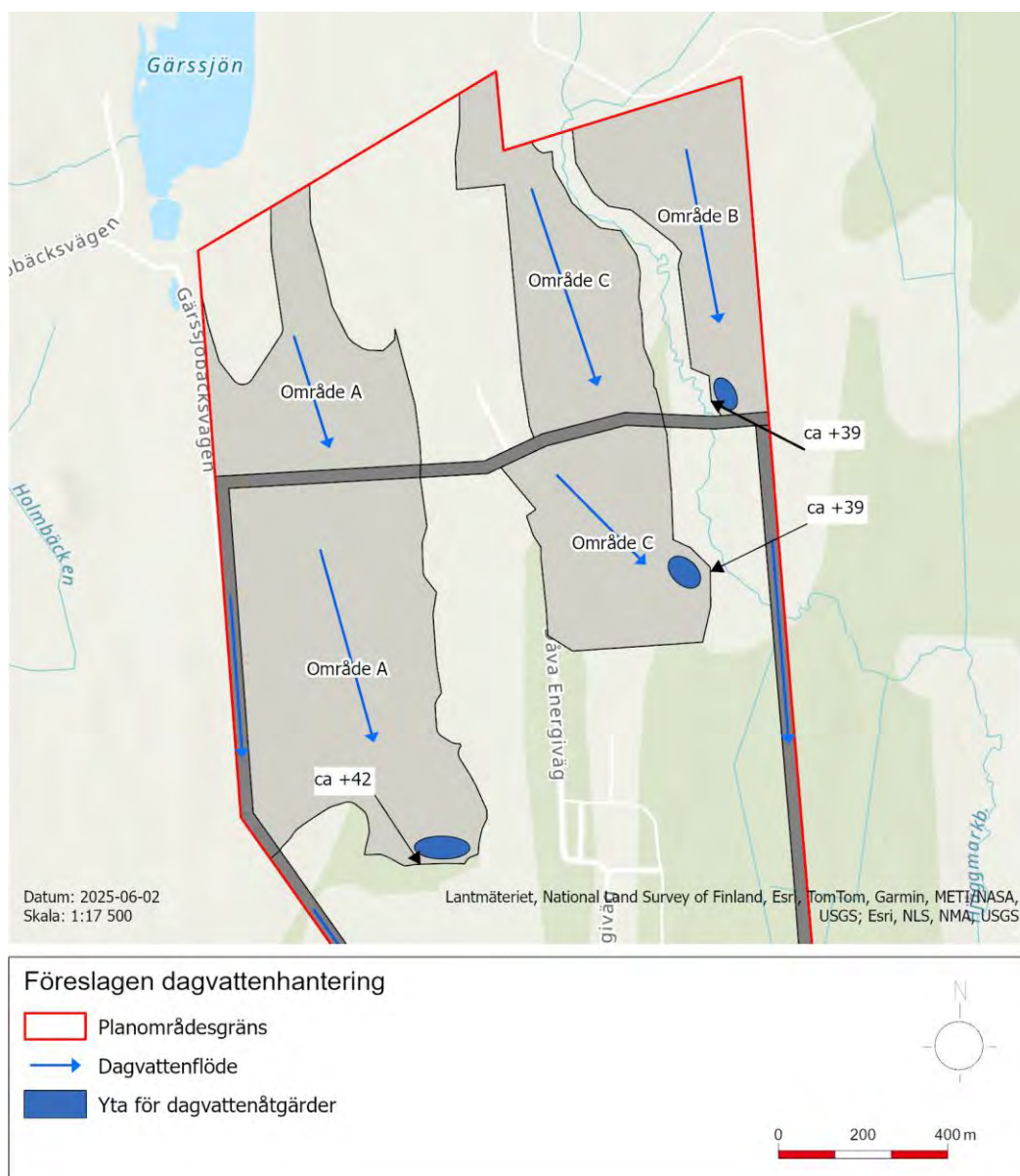
Figur 17 – Schematisk översikt av föreslagen dagvattenhantering för planområdet (norra). Plus-höjder utsatta i figuren anger ungefär vilken höjd avledningspunkter skulle kunna ligga på.
