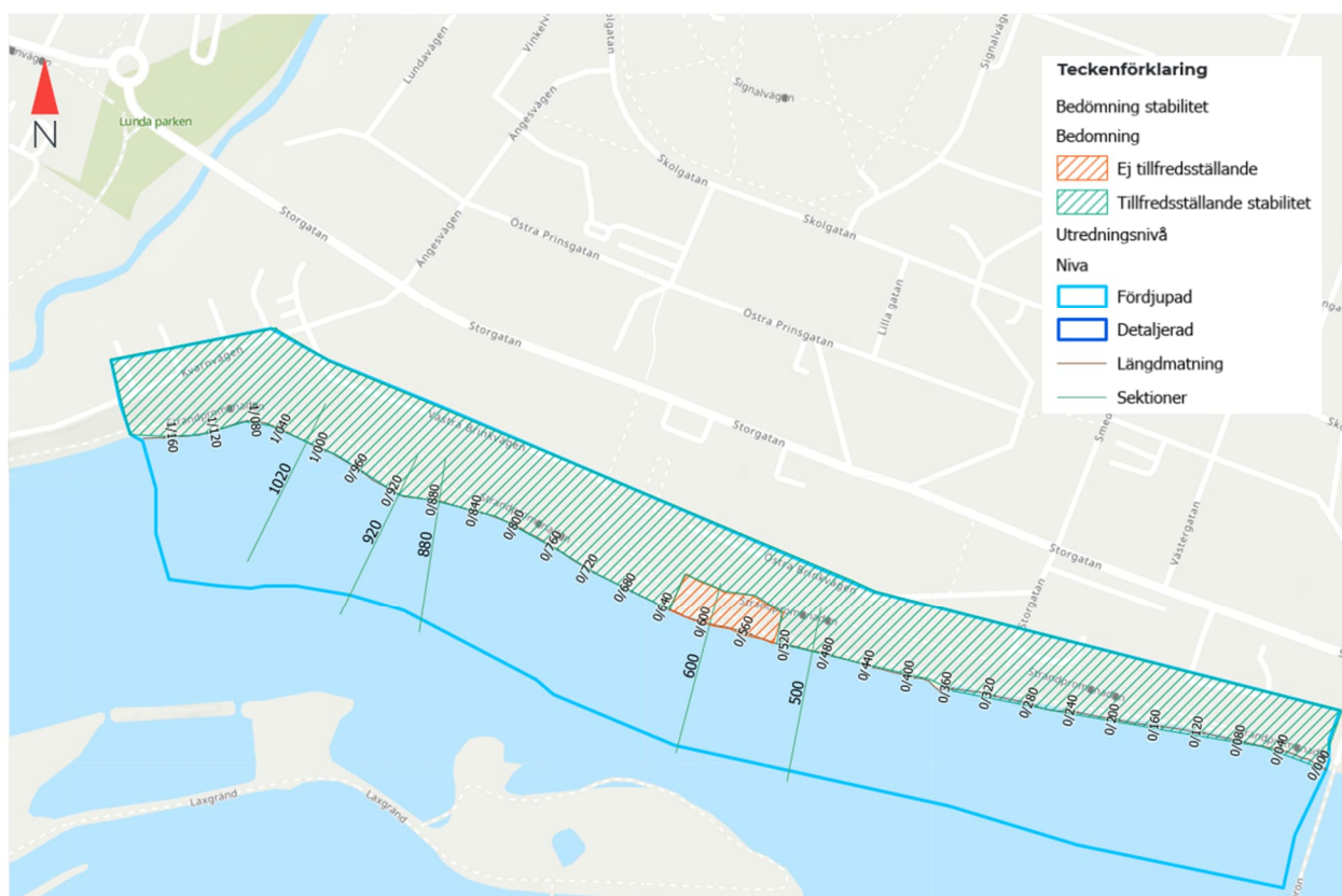
Figur 10-1. Schematisk illustration av utredningsområdet och bedömning av släntstabiliteten, utdrag ur Bilaga 3.
