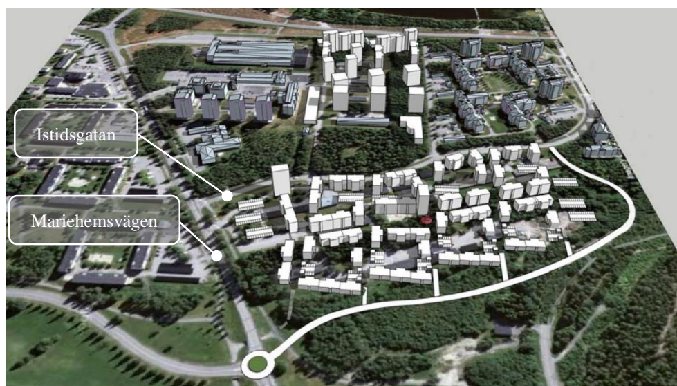
Figur 1-6 Alternativt förslag till ny väg med ny cirkulationsplats i korsningen med Mariehemsvägen. Notera att utformningen vid korsningen Mariehemsvägen/Bofinksvägen är olämplig för busstrafikens framkomlighet. Bild: Planprogram för Olofsdal inom Marieområdet, Samrådshandling november 2012.
