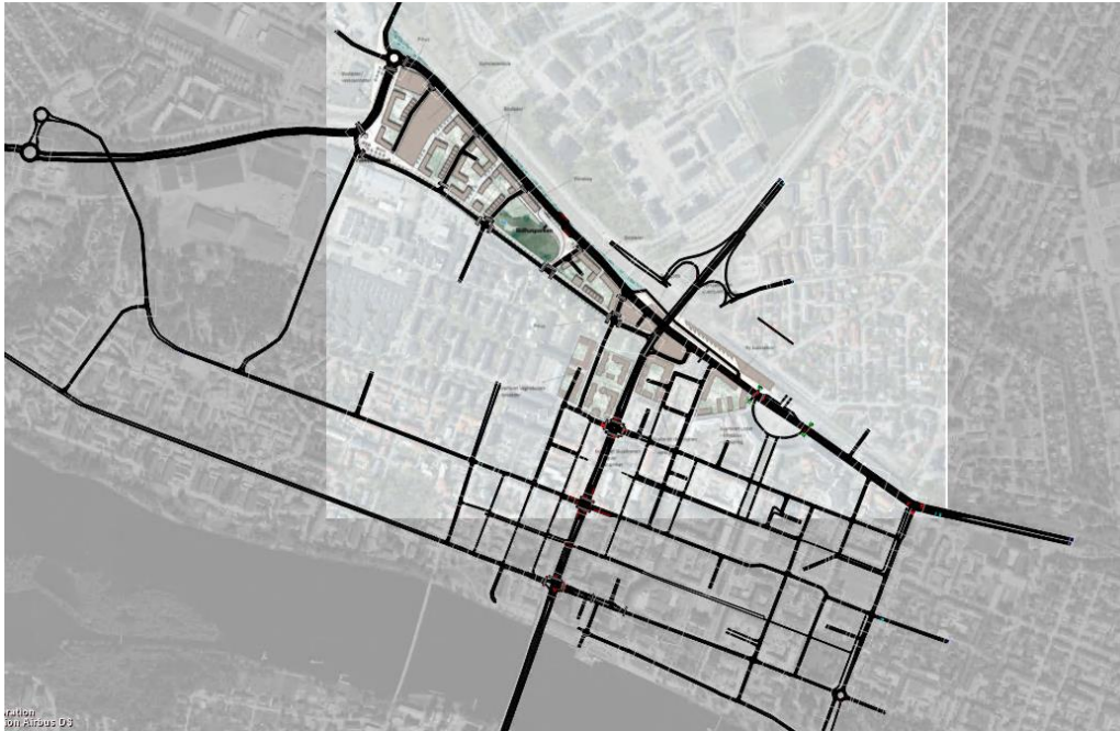
Figur 5-2 Medelköer(rött) under förmiddagens maxtimme, prognosår 2050 med målstyrt resande. Bilden visar att köproblematiken i princip är obefintlig i det målstyrda scenariot.
