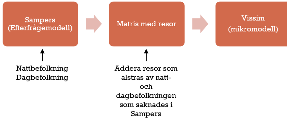
Figur 4-1 Schematisk bild över processen mellan Sampers och Vissim
