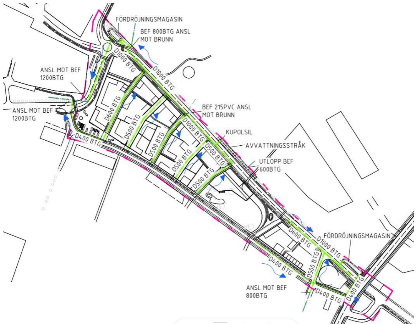
Figur 27, skiss på dagvattenledningsnät med självfall.
