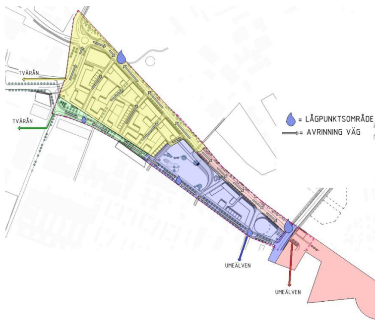
Figur 11, ytavrinning och belastade recipienter efter exploatering och ny höjdsättning av mark.
