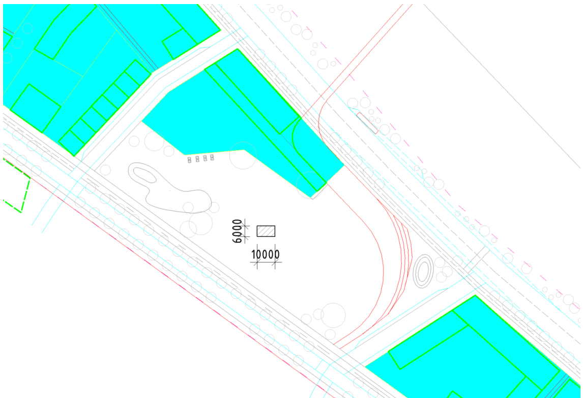
Figur 14. Fördröjning i ridhusparkenområdet med dagvattenkassetter.
