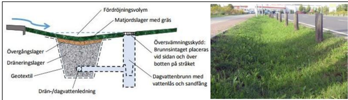
Figur 27. Vänster: Principskiss av ett infiltrationsdike/infiltationsstråk. Höger: Ett exempel på ett dike i gatumiljö. (Bildkälla: WRS)
