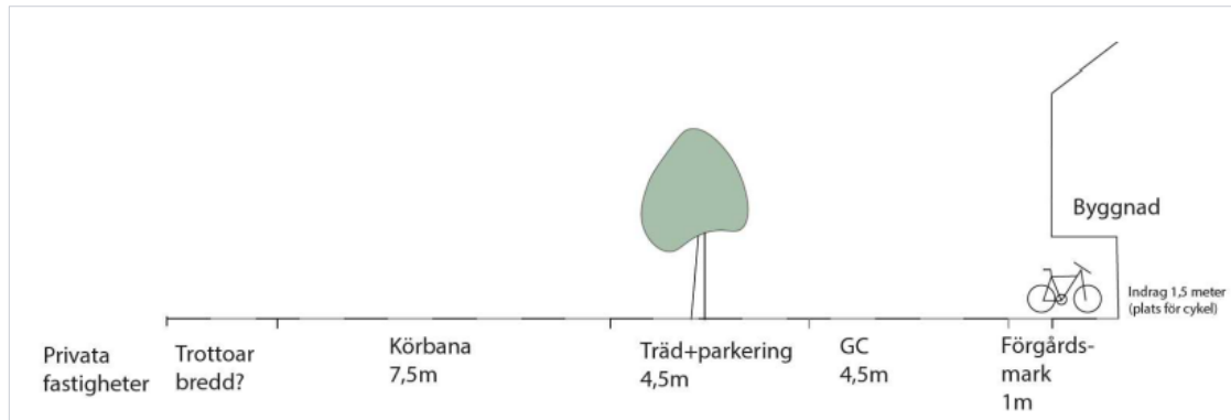
Figur 3: Planerad sektion för Rothoffsvägen
