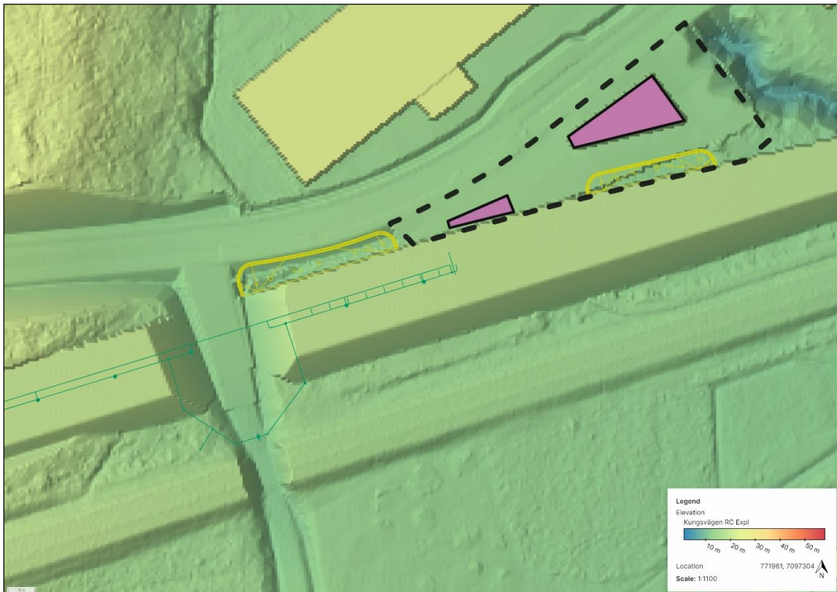
Figur 17. Planerad framtida avvattning av perrong (gröna linjer) och släntytor med plantering (gula linjer)
