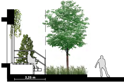
Typ A Denna uppbyggnad av frizon ger tillgänglighet för rullstol och behöver endast ha räcken på kortändarna. Terrassdelen möter gatans grönzon med ett högre "sittsteg".
